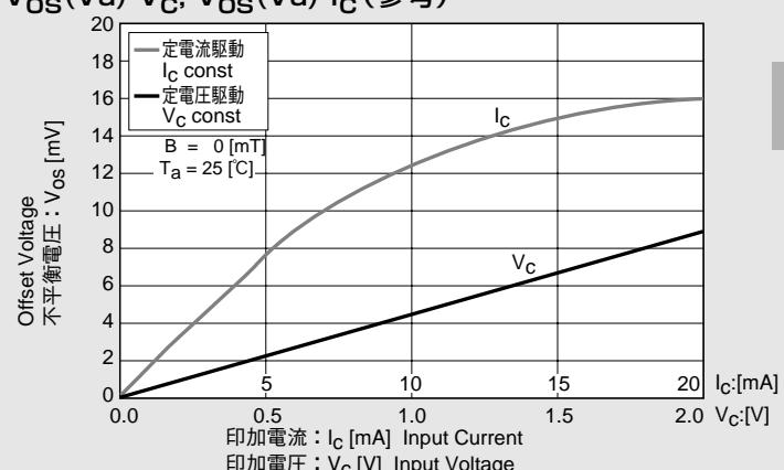
定電圧駆動 R<sub>in</sub>=350 [Ω]、V<sub>OS</sub>=4.7 [mV] [V<sub>C</sub>=1 [V]] の例
